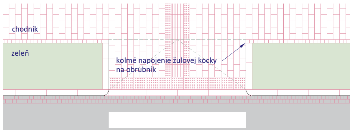
Obrázok 25_Kolmé napojenie žulovej kocky na obrubník
