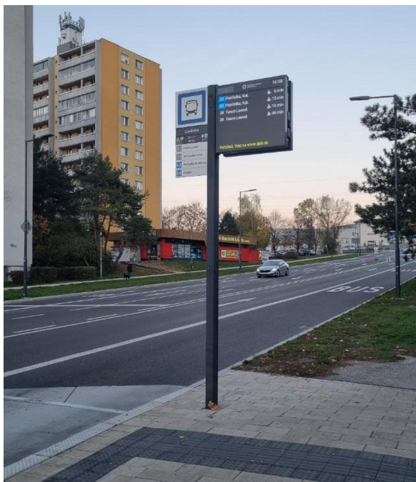
Obrázok 114_Príklad EIT osadenej na zastávkovom stĺpiku s označníkom; zastávka Lipského
